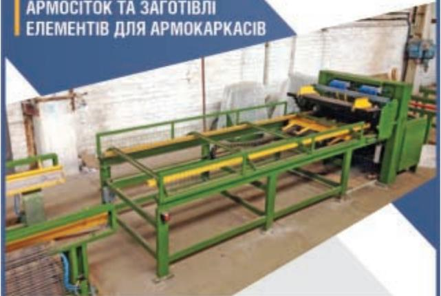
Проведено пусконаладжувальні роботи. Лінія працює та приносить прибуток. Можна виробляти сітку для кладки: Ø 4, 5, 6, шириною від 0,38 м до 1 м, довжиною від 1 м до 6 м. Осередки: 50, 100, 150, 200, 300.
